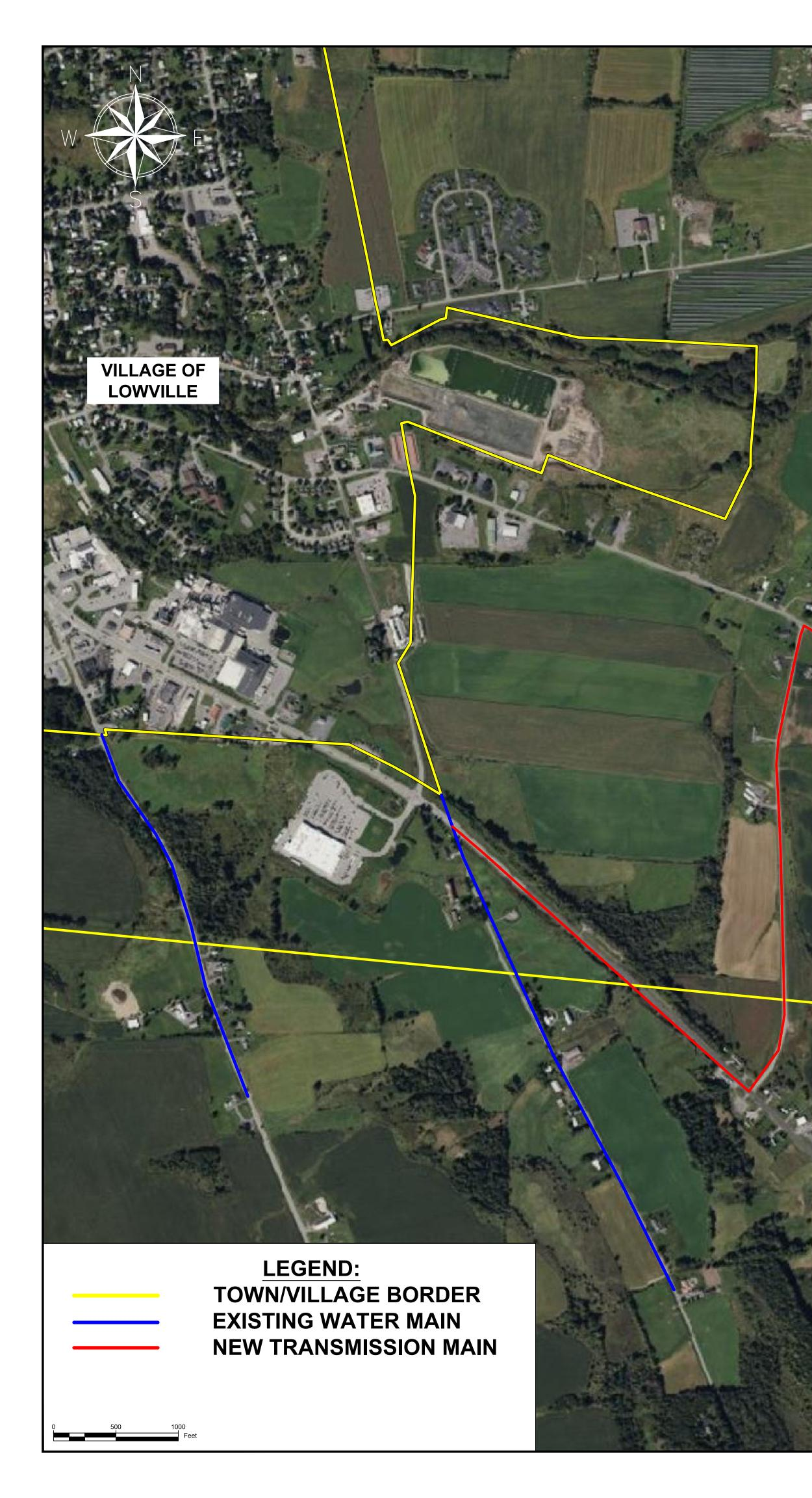
NEW 8-INCH DUCTILE IRON TRANSMISSION LINE
